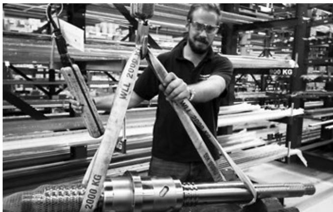
Thomson Hochlast-Kugelgewindetriebe verbessern die Leistung in einem kompakteren Paket, verlängern die Produkt-Lebensdauer und sparen Geld. Ihr einzigartiges Design erhöht die Tragzahlen und macht sie zur idealen Lösung, wenn hohe Verstellkräfte gefordert sind.
